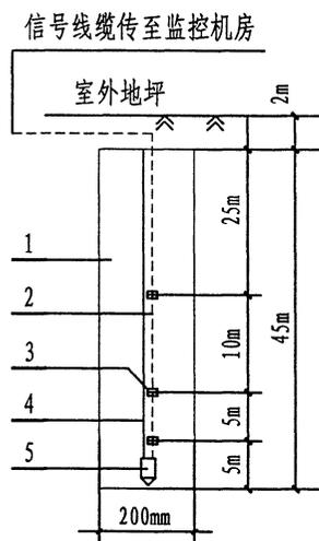
埋管换热器监测井、背景监测井构造做法
