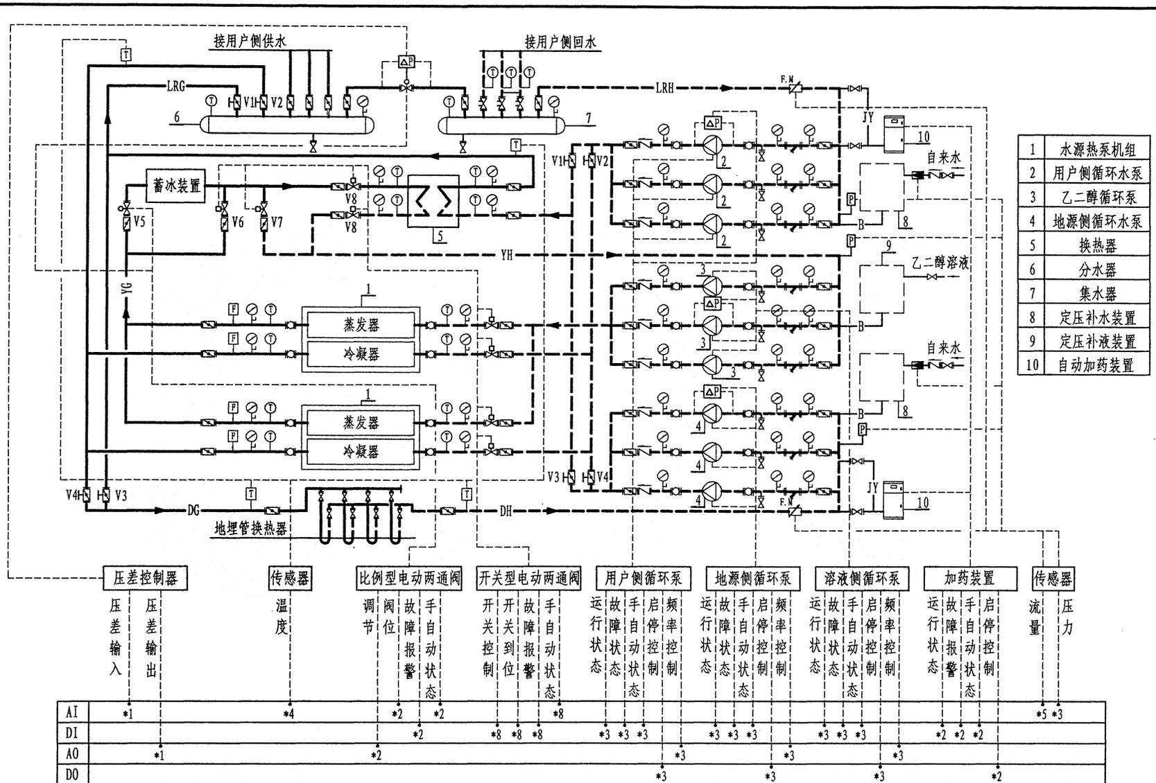
注: 1. 各水泵均应安装压差传感器, 图中由于图幅所限, 不再重复表示。
