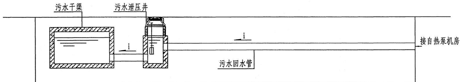
原生污水热泵系统污水回水原理图
