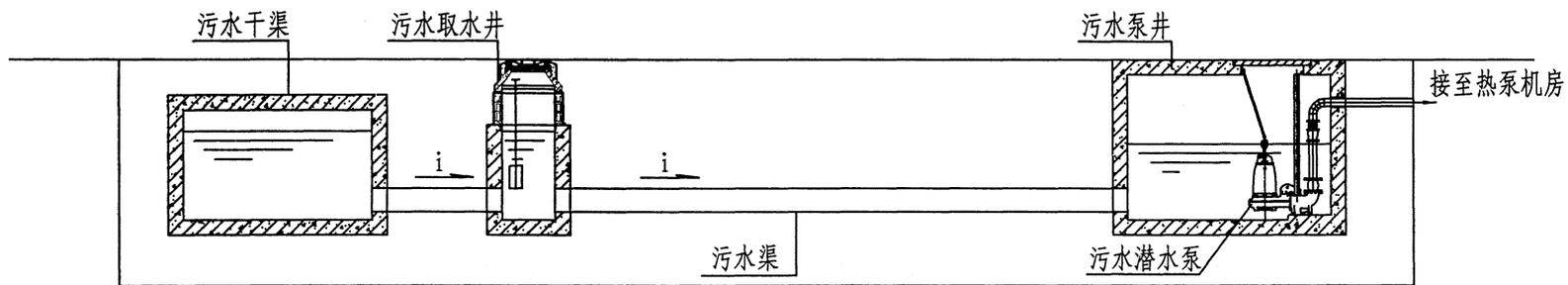
原生污水热泵系统污水取水原理图
